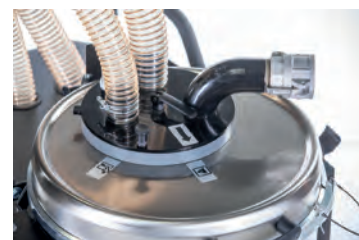
Bedieneinheit der Schubumkehr zur Behälterentleerung (Flüssigkeiten).
